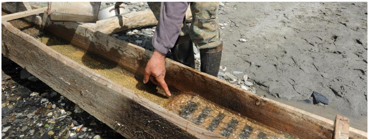
სურ. 40. სვანური ოქროს გასარეცხი ხის გეჯა, რომლის ზედა ნაწილზე იყრება ქვიშა და მასზე მიმდინარე წყალი ამ ქვიშას რეცხავს, ხოლო ოქრო რჩება ბარიერზე.
