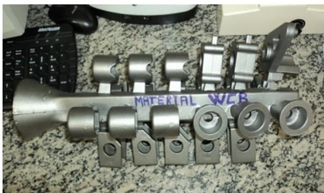
**Figura 12.** Peças microfundidas em WCB presas ao cacho.
