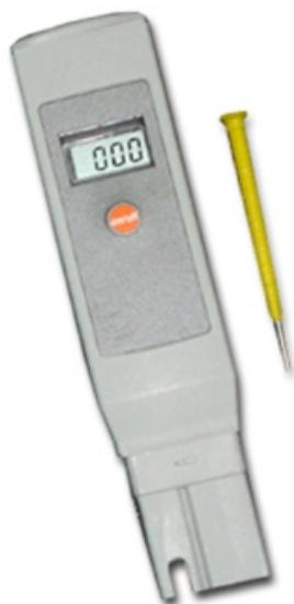
Figura 1 – Condutivímetro portátil; faixa de medição de 0 a 1999  $\mu\text{S}/\text{cm}$ , resolução de  $1\mu\text{S}/\text{cm}$ , precisão de  $\pm 2\%$ .
