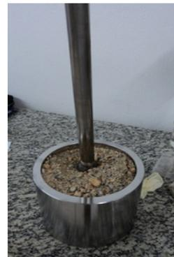
**Figura 2.** Cadinho confeccionado em aço para a trituração manual da casca cerâmica.
