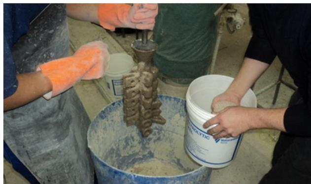
**Figura 6.** Processo de adição manual do chamote.
