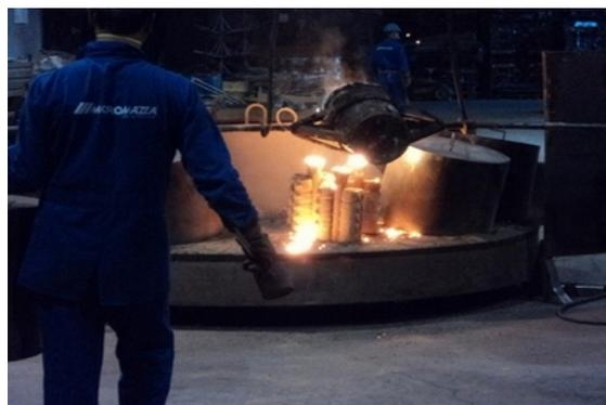
**Figura 7.** Aço vertido em cascas cerâmicas.
