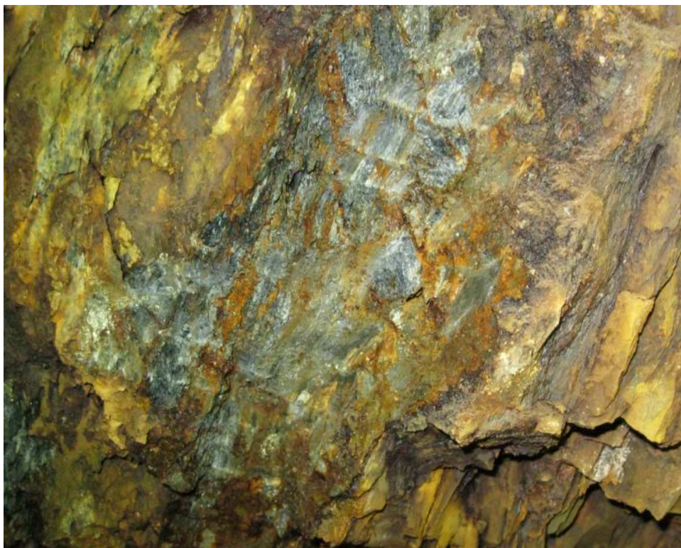
ნახ. 5. 18. სამჭედლოს მარღვის კვარც-ქალკოპირიტულ-პიროტინული მადნის ფრაგმენტი.
