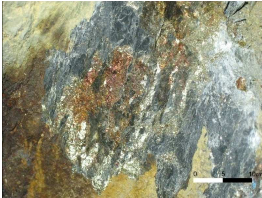
ნახ. 5. 19. „ინგლისური მადნიანი მარღვის“ ზალბანდში ფორმირებული კვარც-პიროტინ-ქალკოპირიტული მარღვაკები, რომელშიც დაფიქსირდა 3.09 გ/ტ ოქროს შემცველობა.
