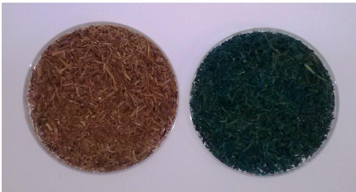
**Figura 2.** Aspecto da fibra de bananeira antes e após a adsorção.
